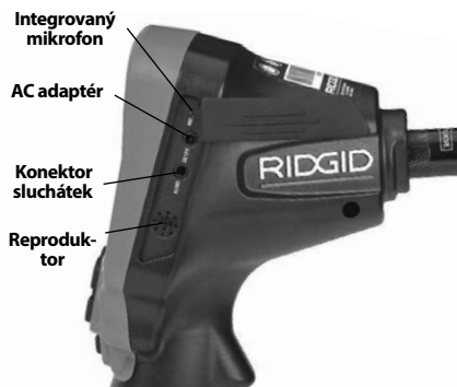
Obrázek 3 – Kryt vstupů na pravé straně
