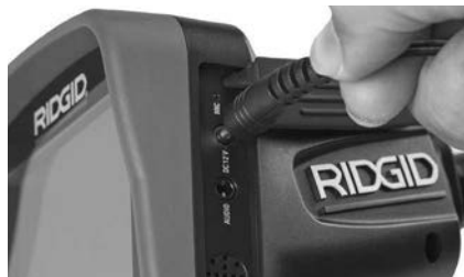
Obrázek 6 – Napájení jednotky pomocí AC adaptéru
